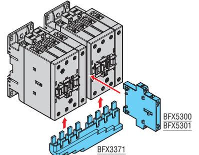
Anschlüsse für Umschalterschütze mit 4-poligen Schützen BF95...BF150
