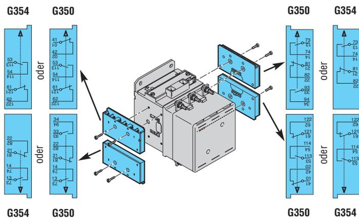
Mit dem Adapter G358 können die Hilfskontakte vom Typ BFX10... mit 2 Kontakten und G484... sowie die zeitgesteuerten Hilfskontakte G485..., G486... und G487 montiert werden (Typen und Bezeichnungen siehe Seite 2-20).
