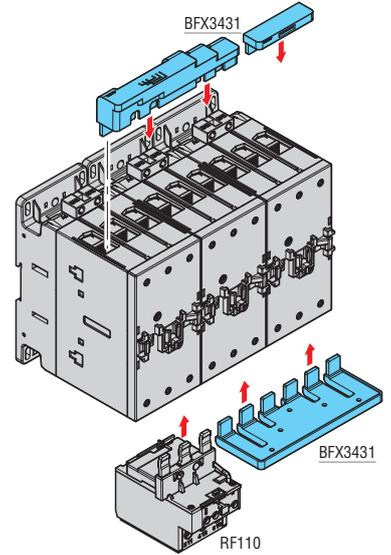
Anschlüsse für Umschalterschütze mit 3-poligen Schützen BF40...BF94
