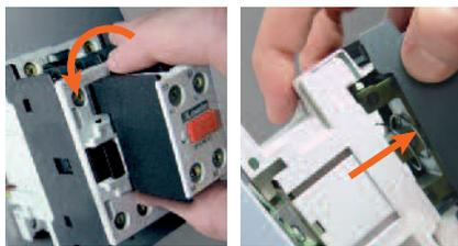
Der Ein- und Ausbau der Hilfskontaktblöcke und des Zubehörs sind einfache Vorgänge, die kein Werkzeug erfordern. Dies gilt auch für den Austausch der Spule bei den Schützen BF09...BF38 in AC.
