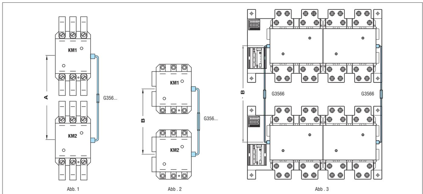
Horizontale und vertikale Verriegelung zwischen Schützen B250...B630
