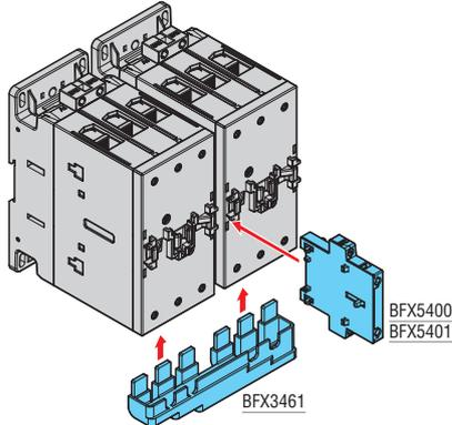
Anschlüsse für Umschalterschütze mit 4-poligen Schützen BF40...BF80
