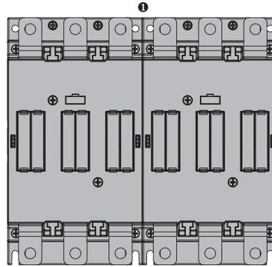
❶ Die Verriegelung BFX5500 wird in den 2 Schützen montiert, ohne dass der Platzbedarf zunimmt.
