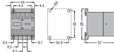
① Empfohlene Bohrung 1,7...2mm
