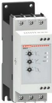
Die ideale Lösung für all jene, die einen sehr leicht konfigurierbaren Motorstarter mit Basisfunktionen suchen, der nur für den sanften Anlauf und Auslauf des Motors dient. Bei der Konfiguration müssen nur 3 Parameter (Beschleunigungszeit, Verzögerungszeit und Anfangsspannung) über 3 **Potentiometer** auf der Vorderseite des Soft-Motorstarters eingestellt werden.
