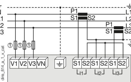
Der Gebrauch von 2 SW verringert die Genauigkeit der Phasen, deren Strom von der vektoriellen Berechnung abgeleitet ist, um 0,5 %.
