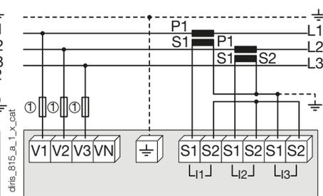
Der Gebrauch von 2 SW verringert die Genauigkeit der Phasen, deren Strom von der vektoriellen Berechnung abgeleitet ist, um 0,5 %.
