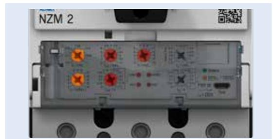
**Fehlerströme gegen Erde werden nach dem Summenstromprinzip mit Hilfe der integrierten Wandler erfasst. Der Leistungsschalter alarmiert oder löst entsprechend der Einstellungen aus, wobei der Einstellbereich von 20 % bis 100 % des Betriebsbemessungsstroms wählbar ist. Die Auslösung ist bis zu einer Sekunde verzögerbar.**
