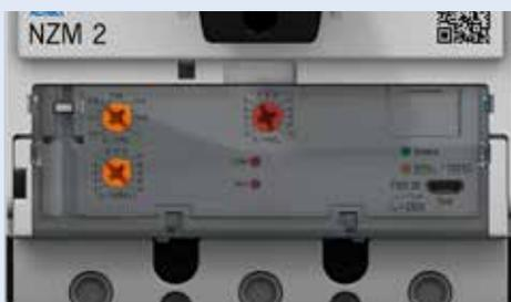
**Leistungsschalter NZM schützen Motoren und Zuleitungen bei Überlast, Kurzschluss und Phasenausfall zuverlässig von 16 A bis 1400 A. Damit das Schutzorgan bei Anlaufspitzen nicht unnötigerweise abschaltet, lassen sich die Kurzschlussauslöser auf das bis zu 18fache des Nennstroms einstellen. Durch einen erweiterten Einstellbereich werden auch energieeffiziente Motoren mit hohen Anlaufströmen geschützt.**
