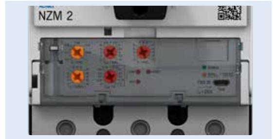
**Als Einspeiseschalter übernimmt der NZM natürlich auch den sekundärseitigen Überlastschutz des Transformators. Eine Variante mit zeitverzögerten Kurzschlussauslösern erlaubt zeitselektiven Netzaufbau. Diese Lösung eignet sich insbesondere bei Transformator- oder Generatoreinspeisung sowie bei langen Leitungen in IT- und TN-Netzen.**
