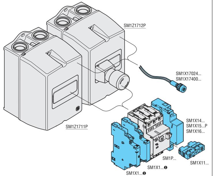
❶ Der Anzeigekontakt SM1X1311M kann nicht alleine in den Gehäusen SM1Z1711P und SM1Z1712P montiert werden, sondern muss mit SM1X12... oder SM1X1311 kombiniert werden.
