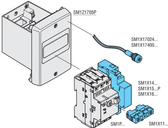
Aufbaugehäuse für SM1R..., Breite 100mm
