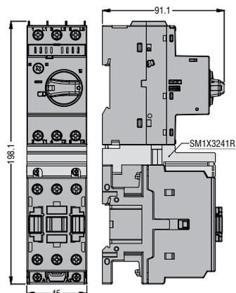
**SM1R... mit abschließbarer Türverriegelung SM1X18200R oder SM1X18B200R**
