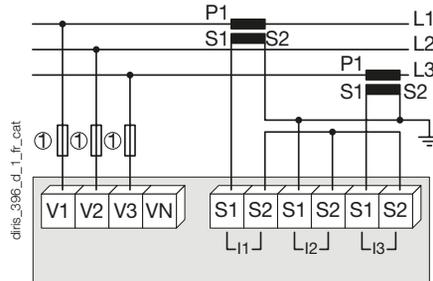
Bei der Lösung mit 2 SW verringert sich die Genauigkeit der Phase, deren Strom vektorieLL errechnet wird, um 0,5 %.
