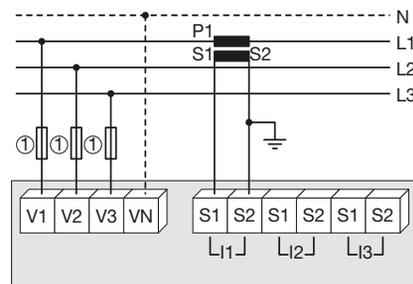
Bei der Lösung mit 1 Stromwandler verringert sich die Genauigkeit der Phase, deren Strom vektoriel errechnet wird, um 0,5 %.
